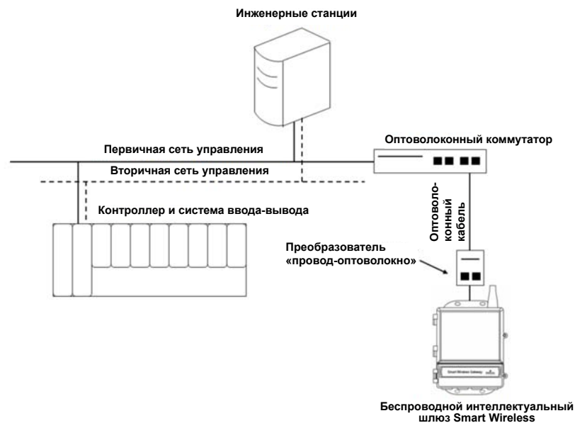
Рис.5-2. Архитектура оптоволоконной ЛВС
